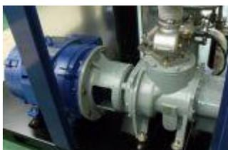
Прямой привод через муфту позволяет избежать передаточных потерь, позволяет экономить электроэнергию и делает компрессор более удобным в обслуживании. Силовая часть, установленная на восьми креплениях, сводит к минимуму вибрации и дает возможность демонтажа двигателя и винтового блока по отдельности.
