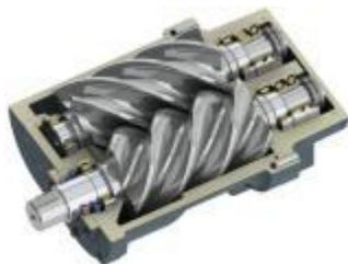
Особое внимание компания COAIRE уделяет качеству винтовых блоков. Строгий контроль качества на всех этапах производства обеспечивает идеальную согласованность работы деталей винтового блока. Длительный ресурс винтовой пары – 100 000 часов – достигается за счёт низких оборотов, трехрядного усиленного подшипника, двойного и тройного сальника для большей герметичности.
